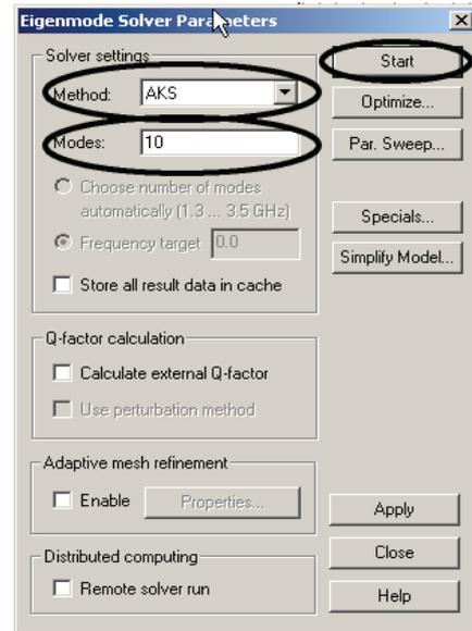
Fig. 56 Eigenmode の設定
