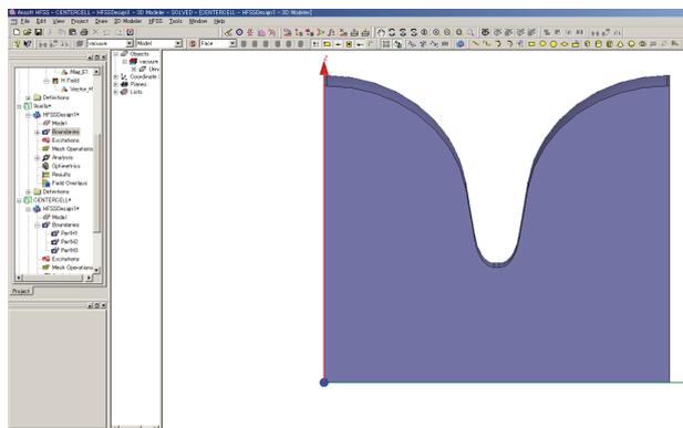
Fig. 24 Eigenmode シミュレーションモデル
